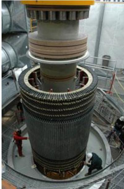
Figura 8. Estructura interna del VFT, fotografía de Langlois [53].
